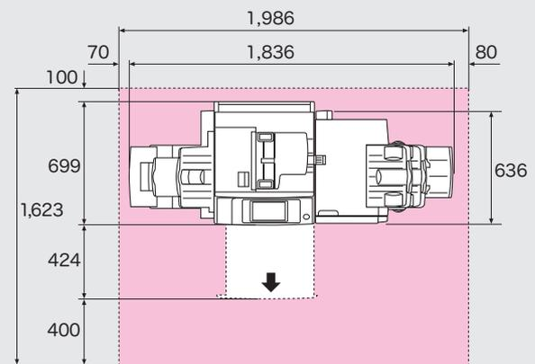
●本体 (自動両面原稿送り装置)+大型カラー操作パネル
