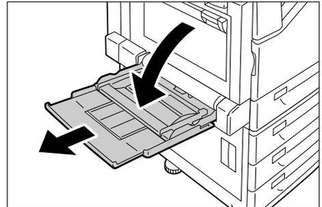
2. 印刷する面を下にして、用紙をセットします。
