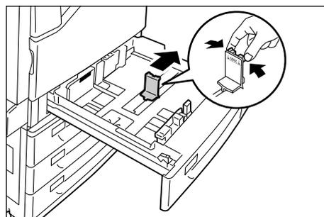
4. 印刷する面を上にして、用紙の先端を左手前にそろえてセットします。
