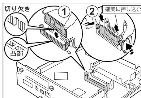
6. コントローラーボードを本体に戻します。コントローラーボードの取っ手を持ち、プリンター本体に差し込みます。
