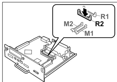
R2 スロットの両側にあるツメを大きく開いたあと、切り欠き部分を本体側の R2 スロットの凸部に正しく合わせて、まっすぐに差し込み、さらに両側を上から強く押し込みます。
