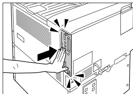
9. 2か所のネジを締めて、コントローラーボードを固定します。
