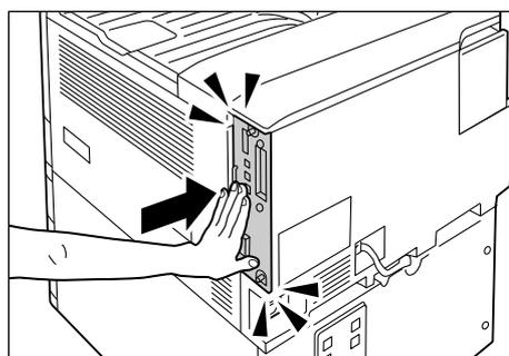
8. 2か所のネジを締めて、コントローラーボードを固定します。
