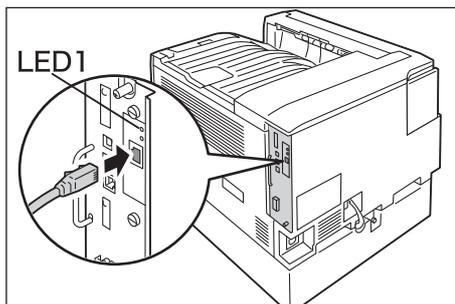
3. ネットワークケーブルの他方のコネクタを、ハブなどのネットワーク機器に接続します。
