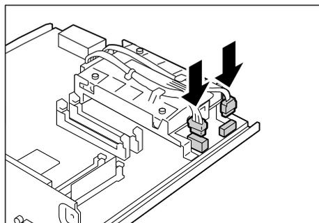
7. コントローラーボードを本体に戻します。コントローラーボードの取っ手を持ち、プリンター本体に差し込みます。
