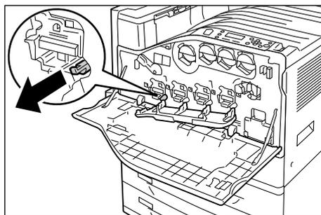
5. 清掃棒を止まるまで引き出したら、元に戻す操作を2～3回繰り返して清掃します。
