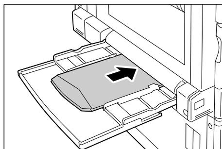
2. 用紙ガイドを、セットした封筒のサイズに合わせます。
