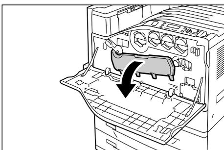
4. ドラムカートリッジの取り付け部の右下に入っている清掃棒を引き出します。
