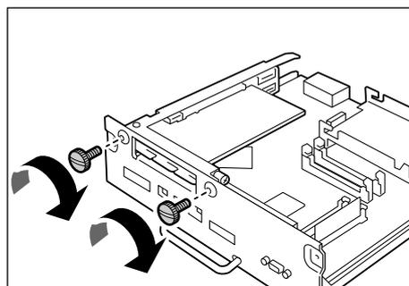
8. コントローラーボードを本体に戻します。コントローラーボードの取っ手を持ち、プリンター本体に差し込みます。
