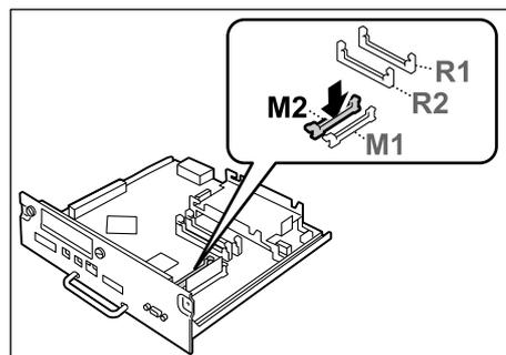
切り欠き部分を本体側の M2 スロットの凸部に正しく合わせて、まっすぐに差し込み、さらに両側を上から強く押します。
