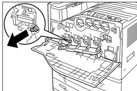
5. 清掃棒を止まる場所まで引き出したら、元に戻す操作を2～3回繰り返して清掃します。
