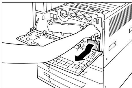
9. 図のように、もう一方の手を添えて、トナー回収ボトルを引き抜きます。
