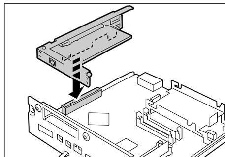
7. 手順5で外したネジで、外側からギガビットイーサネットカードを固定します。
