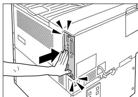
7. 2か所のネジを締めて、コントローラーボードを固定します。
