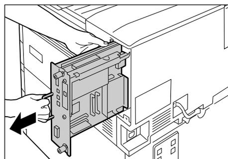
5. ギガビットイーサネットカードを固定している2か所のネジを外します。
