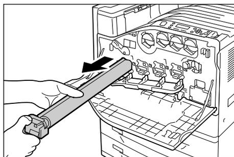
5. 使用済みドラムカートリッジは、新しいドラムカートリッジの箱に同梱されているポリ袋に入れ、新しいドラムカートリッジを取り出したあと、その箱にしまいます。
