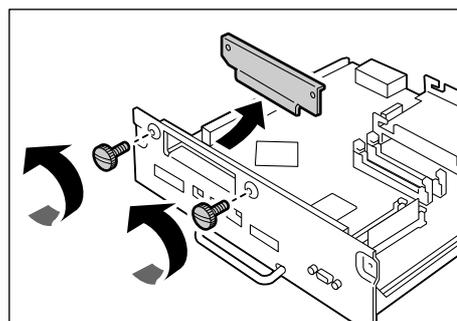
6. ギガビットイーサネットカードとコントローラーボードのコネクターを合わせて、上から差し込みます。
