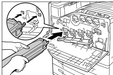
7. 先端を差し込んだ状態で、上面の黒の保護紙を引き抜きます。
