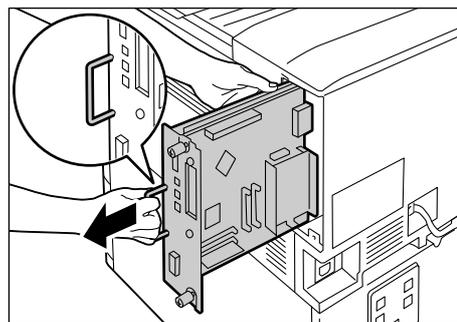
5. コントローラーボード上の2か所のネジを外し、ダミーの板を取り外します。
