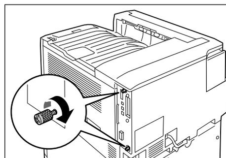
10. 変換ケーブルを平行ポートのコネクターに接続します。
