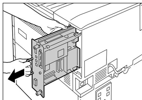
5. パラレルポートを固定している2か所のネジを外します。
