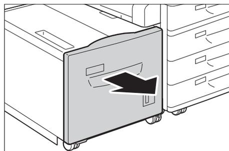
2. 印刷する面を上にして、用紙の先端を左側にそろえてセットします。
