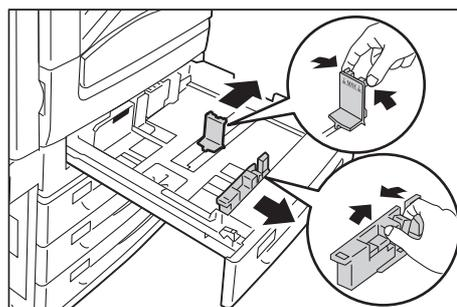
3. 印刷する面を上にして、用紙の先端を左側にそろえてセットします。
