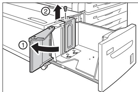
4. ガイドの下部にある突起を、用紙サイズの穴に差し込み (①)、ガイドの上面にある用紙サイズの穴に、トレイの突起を差し込んで、ネジを締めます (②)。
