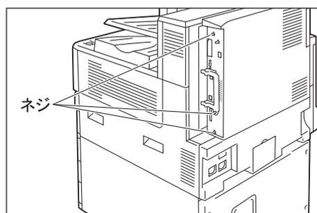
12. ネットワークケーブルを Gigabit イーサネットボードのインターフェイスコネクタに差し込みます。
