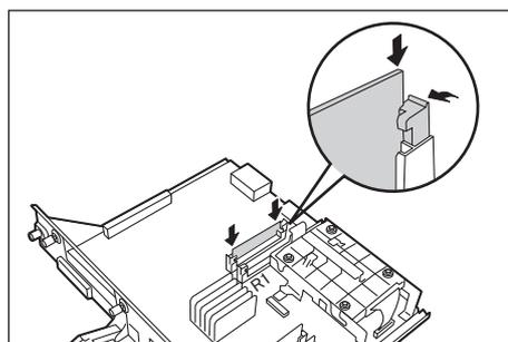
8. コントローラーボードを本体に戻します。コントローラーボードの取っ手を持ち、プリンター本体に差し込みます。
