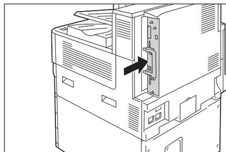
9. 3か所のネジを締めて、コントローラーボードを固定します。
