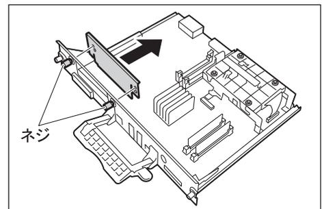
8. Gigabit イーサネットボードとコントローラーボードのコンネクターを合わせて、上から差し込みます。
