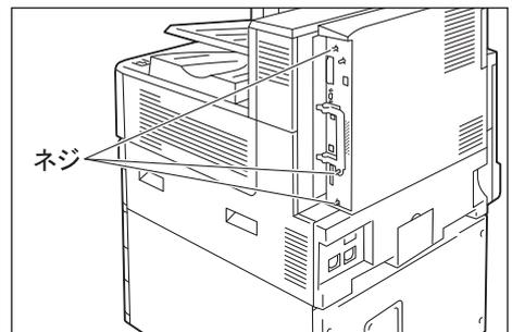
6. コントローラーボードの取っ手を引き出したら、取っ手を持ってコントローラーボードをゆっくり取り出し、机などの平らな場所に置きます。
