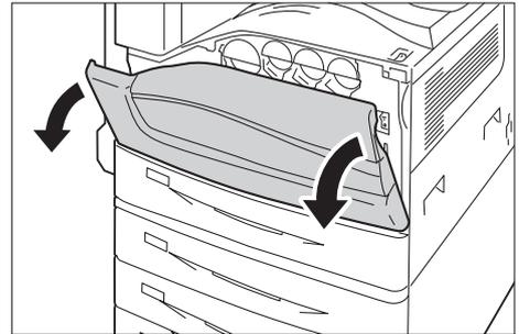
3. 主電源スイッチの〈O〉側を押して、主電源を切り、フロントカバーを閉じます。
