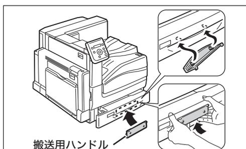
6. 本機を持ち上げて、静かに移動します。長距離を移動する場合は、本機を梱包して運送してください。
