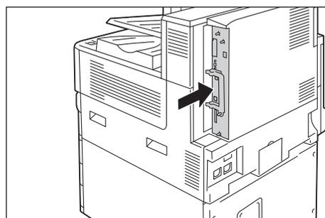
11. 3か所のネジを締めて、コントローラーボードを固定します。
