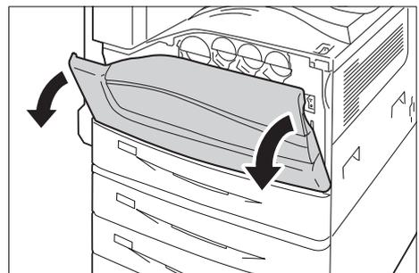
3. 主電源スイッチの〈○〉側を押して、主電源を切り、フロントカバーを閉じます。
