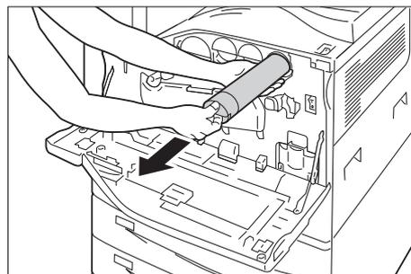
4. 取り出したトナーカートリッジと同じ色の、新しいトナーカートリッジを用意し、図のように軽く 10 回上下左右によく振ります。
