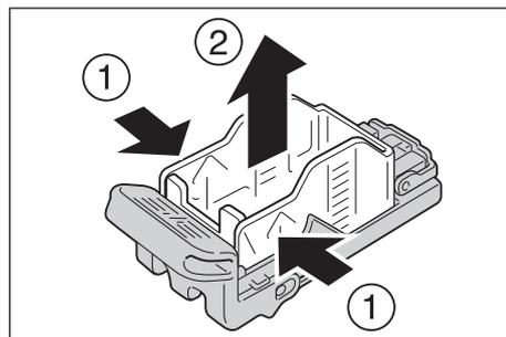
5. 新しいホチキス針ケースを用意し、ホチキスカートリッジに新しいホチキス針ケースを先端から挿入し (①)、後方を押してセットします (②)。
