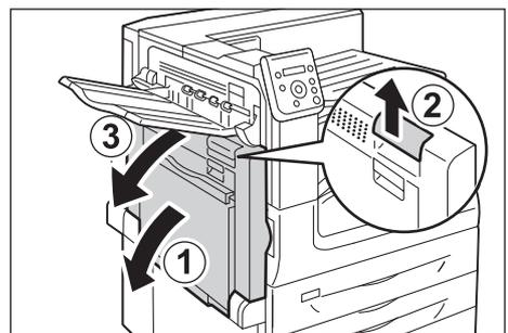
3. レバーを持ち上げて、左側面最上部カバー D を開きます。
