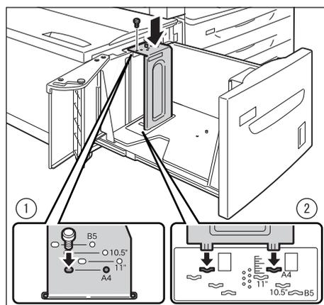
5. 手前のガイドのネジを外し、ガイドを用紙トレイから外します。
