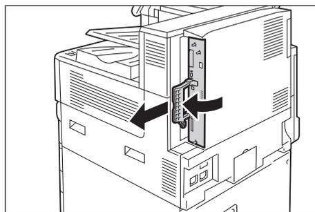
7. セキュリティ拡張キット ROM は、右図の R2 スロットの両側にあるツメを大きく開いたあと、切り欠き部分を本体側の R2 スロットの凸部に正しく合わせて、まっすぐに差し込みます。
