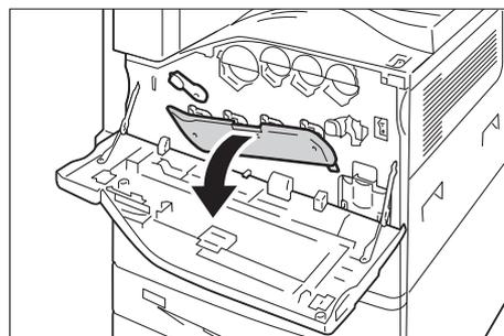
4. LED プリントヘッド部に付属している清掃棒を止まるところまでゆっくり引き出します。清掃棒は、ドラムカートリッジ（R1～R4）下の清掃口にあります。
