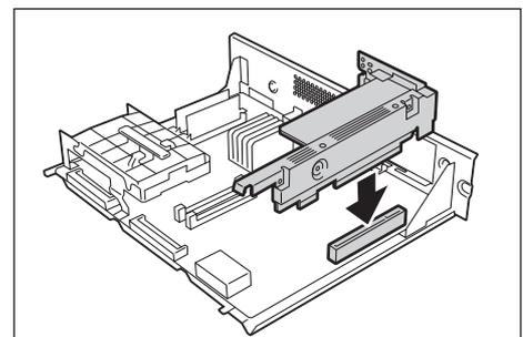
9. 手順7で外したネジで、外側から Gigabit イーサネットボードを固定します。
