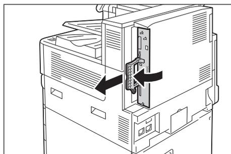
7. 増設メモリーは、右図の M2 スロットに切り欠き部分を本体側の M2 スロットの凸部に正しく合わせて、まっすぐに差し込みます。
