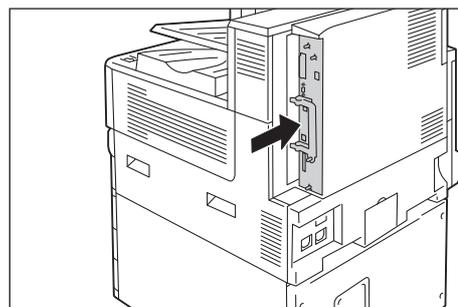
10. 3か所のネジを締めて、コントローラーボードを固定します。
