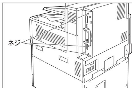
6. コントローラーボードの取っ手を引き出したら、取っ手を持ってコントローラーボードをゆっくり取り出し、机などの平らな場所に置きます。
