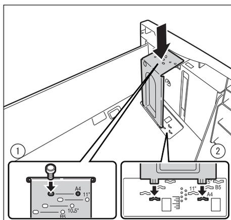
7. 図のようにエンドガイドのレバーを引き上げ (①)、レバーを溝に沿って移動させながら用紙サイズに合わせて (②)、レバーを下ろします (③)。
