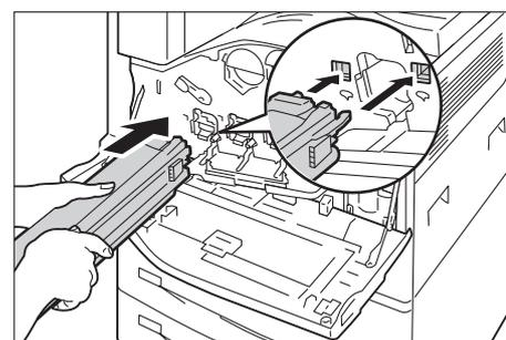
8. 片手で保護カバーを支えながら、先端を差し込んだ状態で、黒紙を左側へ、引き抜きます。
