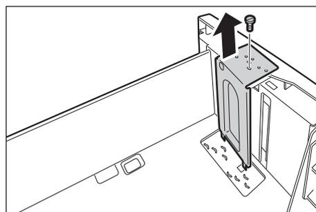
6. ガイドの下部にある突起を、用紙サイズの穴に差し込み (①)、ガイドの上面にある用紙サイズの穴に、トレイの突起を差し込んで、ネジを締めます (②)。
