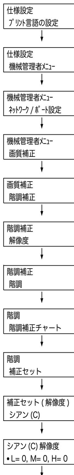
12. <▶> ボタンでフィールド (L: 低濃度 / M: 中濃度 / H: 高濃度) を移動しながら、<▲> <▼> ボタンで補正值を入力します。(例: H=-2)
