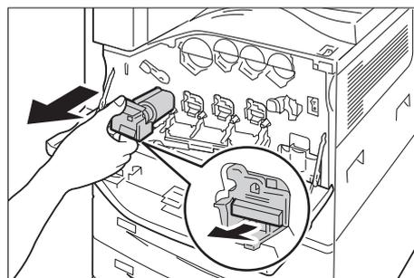
5. 図のように、ドラムカートリッジの下側を支えて、ドラムカートリッジを引き抜きます。
