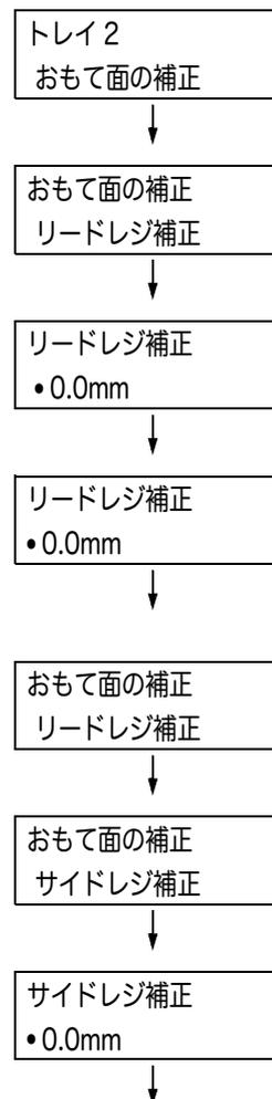
22. 手順 14 で計算した水平方向の補正量を設定し、〈OK〉ボタンを選択します。
