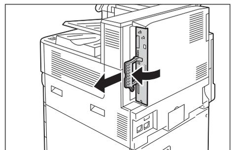
7. Gigabit イーサネットボードを固定している2か所のネジを外します。
