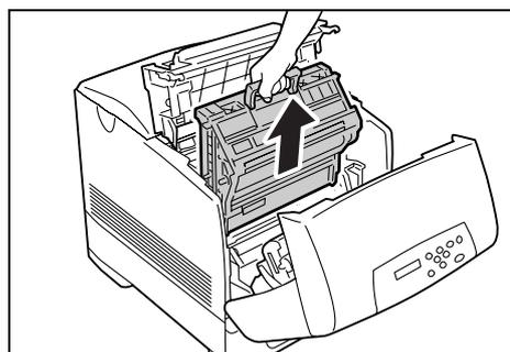
5. 新しいドラムカートリッジを取り出し、保護カバーを取り外します。
