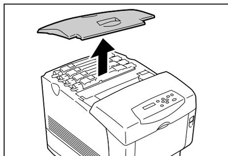
2. 交換したい色のトナーカートリッジ両端のつまみを持って上方方向に回し、ロックを外します。
