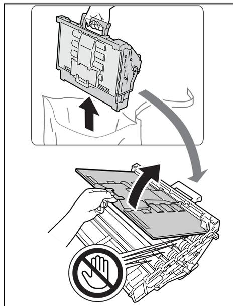
6. ドラムカートリッジの平らな方を、プリンターの背面に向けてハンドルを持ち、ドラムカートリッジ両側にある矢印がついた突起部を、プリンターの矢印ラベルが示す溝に合わせます。ドラムカートリッジを静かにプリンターに挿入します。
