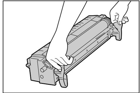
5. 転写ロールカートリッジの矢印とプリンターの矢印を合わせて、プリンター本体に挿入します。
