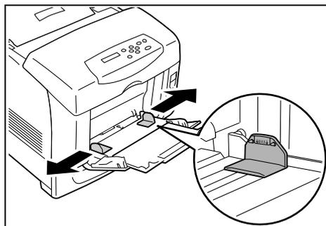
3. 用紙を印刷する面を下にして、上端を奥にしてセットします。
