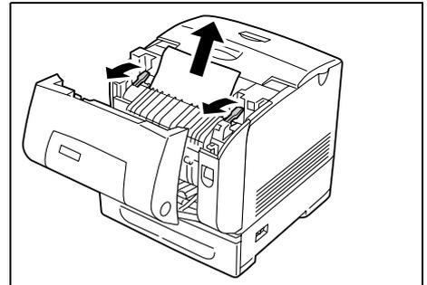
2. フューザーユニットの両端にあるレバーを元に戻し、フロントカバーを閉じます。
