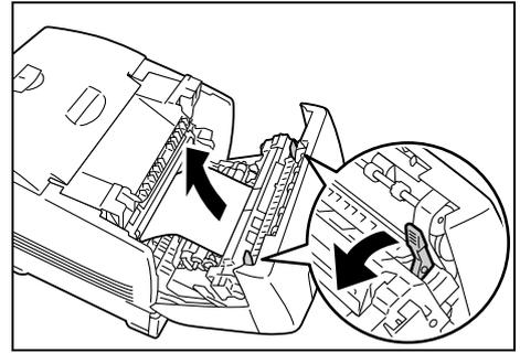
2. フューザーユニットの両端にあるレバーを元に戻します。
